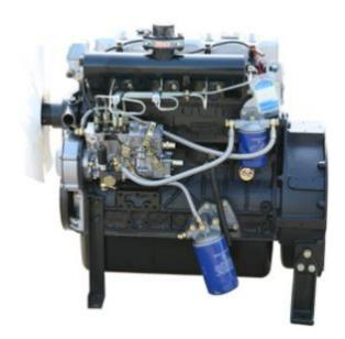
Дизельный двигатель YangDong Y4100D (30 кВт 1500 об/мин.) — является Предназначен модификацией тракторного двигателя. ДЛЯ интенсивного использования в качестве привода Дизель генератора. Обладает высокой надежностью и ремонтопригодностью. Средний показатель наработки до капремонта составляет 15-18 тыс. моточасов.
