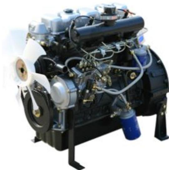
Дизельный двигатель YangDong Y4102D (33 кВт 1500 об/мин.) — является модификацией тракторного двигателя. Предназначен для интенсивного использования в качестве привода Дизель генератора. Обладает высокой надежностью и ремонтпригодностью. Средний показатель наработки до капремонта составляет 15-18 тыс. моточасов.
